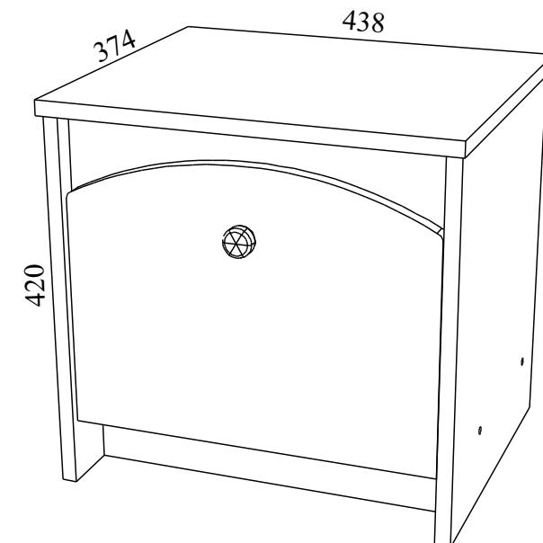
Габаритные размеры: длина - 438 мм, высота - 420 мм, глубина - 374 мм.
