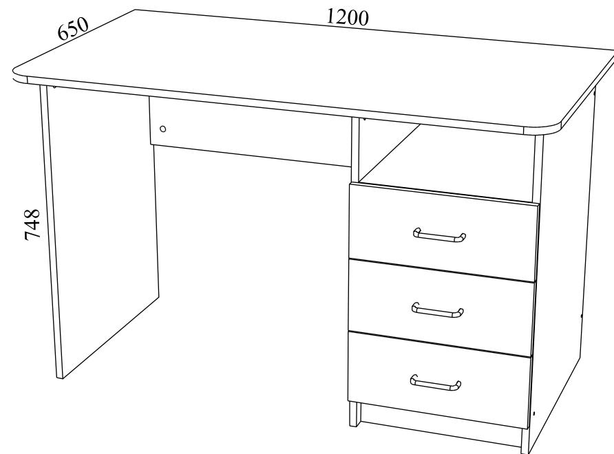
Габаритные размеры: длина - 1200 мм, высота - 748 мм, глубина - 650 мм
