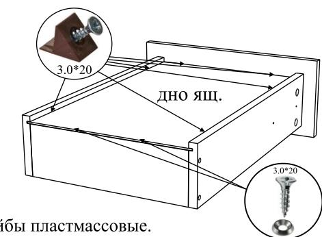
Стенка задняя ящика крепится к бокам ящика евровинтами, фасад ящика - стяжками эксцентриковыми.
