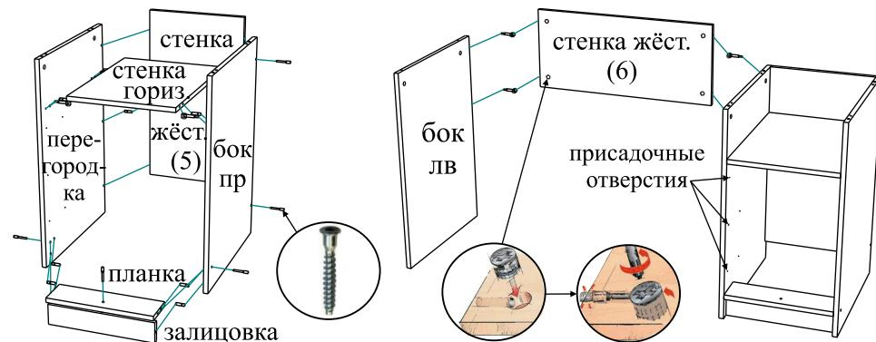
Крышка крепится к бокам и перегородке шкантами и стяжками эксцентриковыми.
