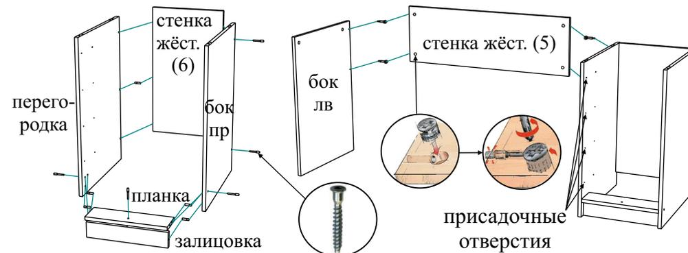
Крышка крепится к бокам и перегородке шкантами и стяжками эксцентриковыми.
