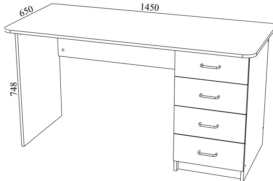
Габаритные размеры: длина - 1450 мм, высота - 748 мм, глубина - 650 мм.
