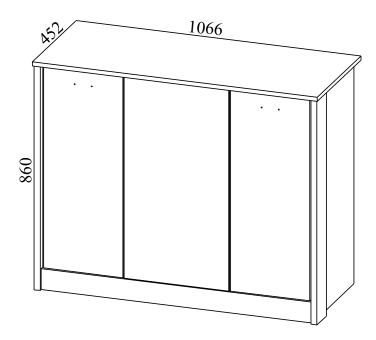
Габаритные размеры: длина - 1066 мм, высота - 860 мм, глубина - 452 мм.
