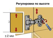
Слегка ослабить крепежные винты ответной планки, вывернуть по высоте позицию двери. Затем крепежные винты снова затянуть.
