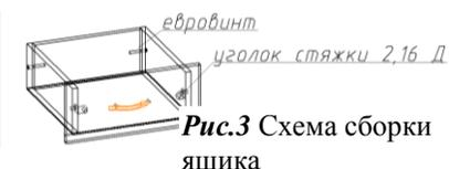
**Рис.3** Схема сборки ящика
