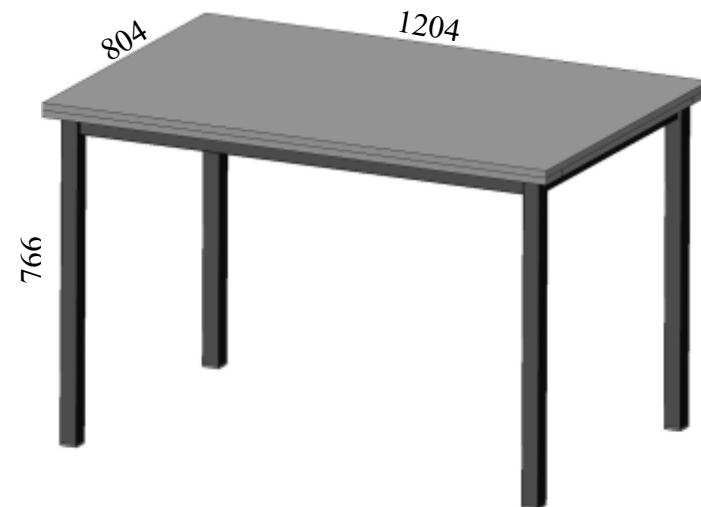
Габаритные размеры: длина - 1204 мм, высота - 766 мм, глубина - 804 мм.
