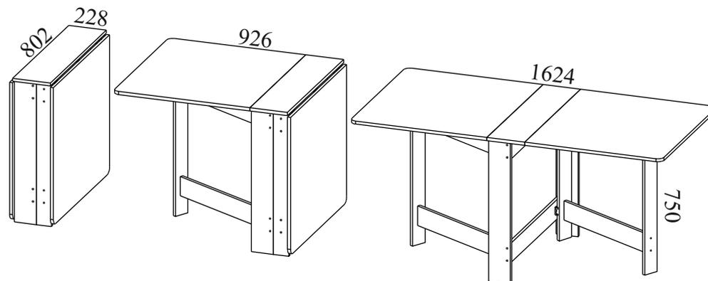
Габаритные размеры: ширина - 228(926/1624) мм, высота - 750 мм, глубина - 802 мм.
