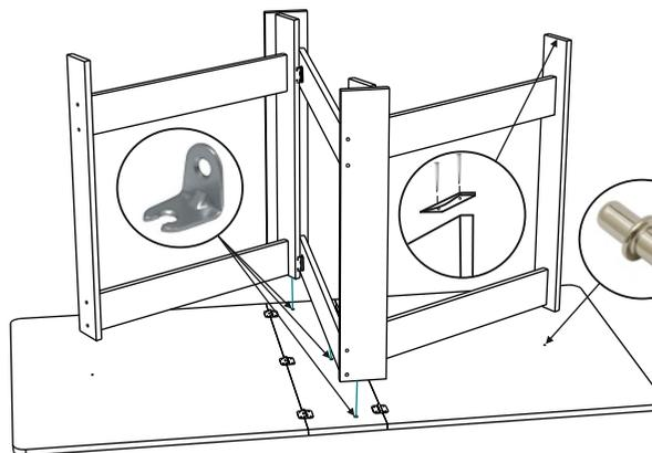
Собранные конструкции скрепляются петлями карточными с помощью саморезов 3.5\*16. Аналогично скрепляются крышки.
