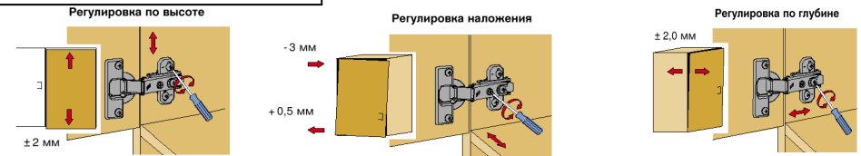
Рис.3 Схема установки петель
