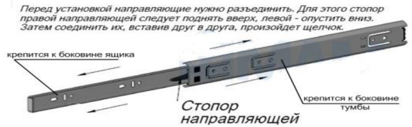
Рис.2 Схема установки шариковых направляющих
