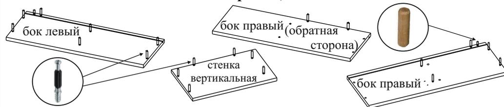
На бока устанавливаются шканты и штоки эксцентриков, на стенку вертикальную - штоки эксцентриков.
