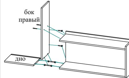
Бок правый крепится к щиту заднему стяжками эксцентриковыми, к стенке горизонтальной верхней - евровинтами. Дно, бок правый и стенка горизонтальная нижняя соединяются стяжкой эксцентриковой двухсторонней.
