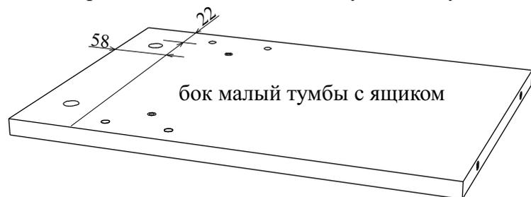
Для крепления направляющих к бокам тумбы с ящиком, проводятся горизонтальные осевые линии, отступая от верхнего края боков 58 мм, от переднего края бока - 22 мм.
