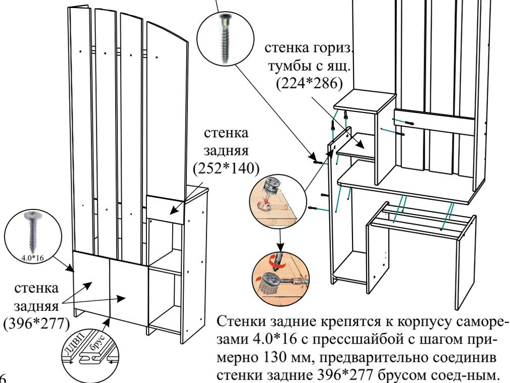
Стенки задние крепятся к корпусу саморезами 4.0\*16 с прессшайбой с шагом примерно 130 мм, предварительно соединив стенки задние 396\*277 брусом соединительным.
