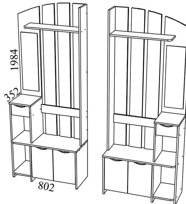
Габаритные размеры: длина - 802 мм, высота - 1984 мм, глубина - 352 мм.
