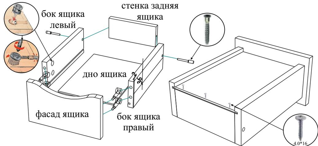
Для крепления направляющих к бокам ящика, проводится горизонтальная осевая линия, отступая от верхнего края бока ящ. 36 мм. Крепится направляющая саморезами 3.5\*16, отступая от переднего края бока ящика 2 мм.
