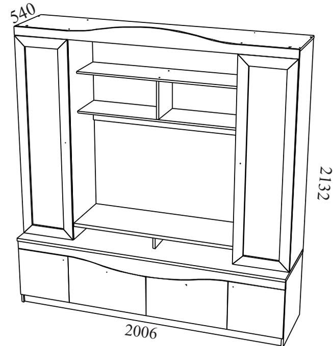
Габаритные размеры: длина - **2006 мм**, высота - **2132 мм**, глубина - **540 мм**.
