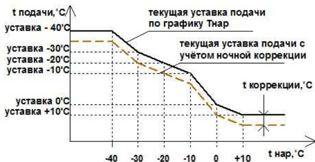
рис. 5 Задание подачи отопления и ночная коррекция
