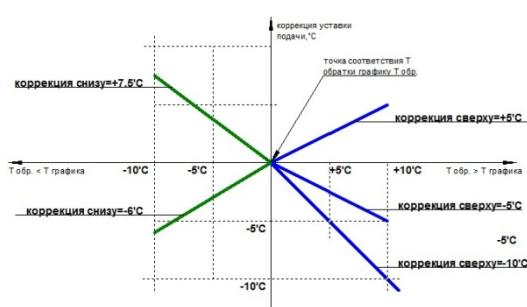
Рис. 7 Расчёт коррекции по обратке.
