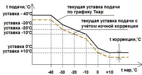
рис. 5 Задание подачи отопления и ночная коррекция
