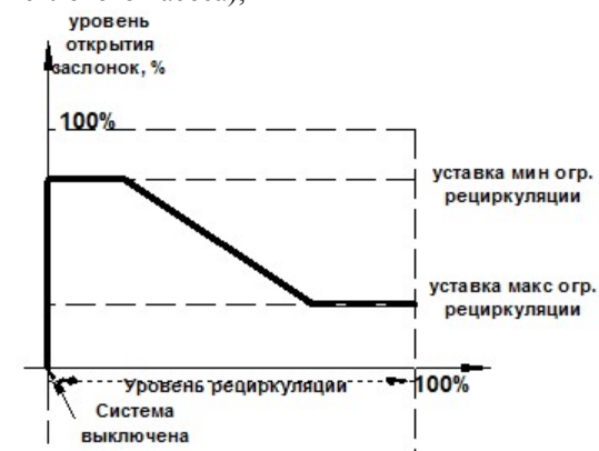
Рис. 7 Зависимость положения приводов от работы регулятора рециркуляции.
