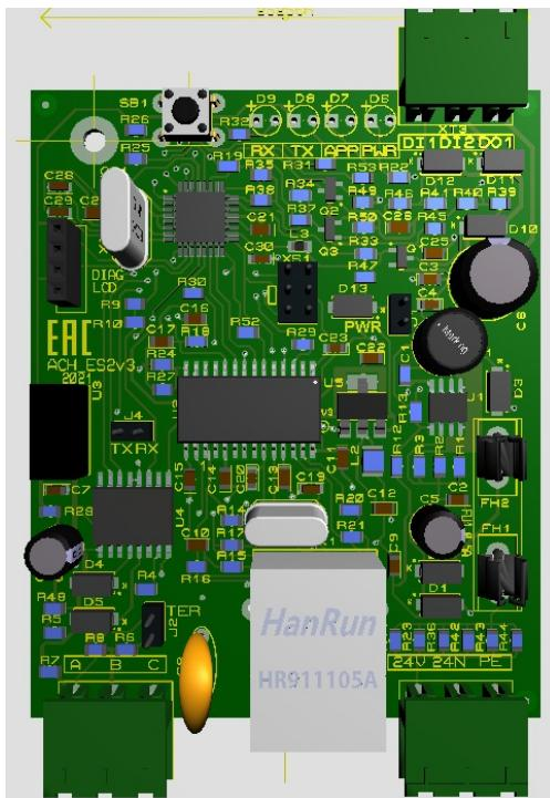
Рис 2. Внешний вид преобразователя со снятой крышкой.
