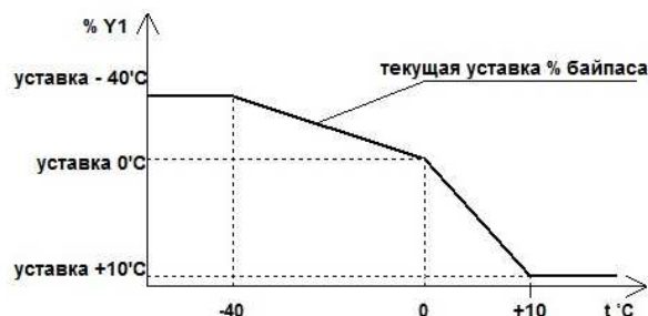
Рис. 5 График работы байпаса в автоматическом режиме.
