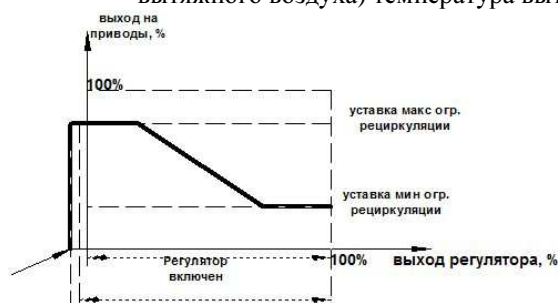
Рис. 7 Зависимость положения приводов от работы регулятора рециркуляции.
