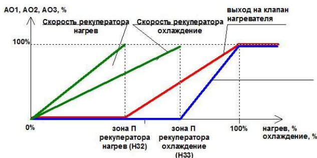
Рис. 6б. Работа роторного рекуператора в прямом режиме регулирования.
