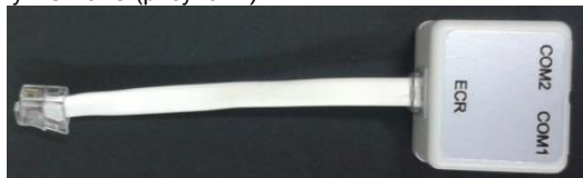
Рисунок 2 – Дополнительный модуль для доступа ко второму порту RS-232C
