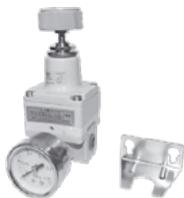
Прецизионный регулятор давления IR предназначен для понижения давления сжатого воздуха и поддержания его на заданном уровне с высокой точностью. Обладает высокой скоростью деаэрации, точной установкой давления. Модификации с пилотным управлением и возможностью монтажа на плите.
