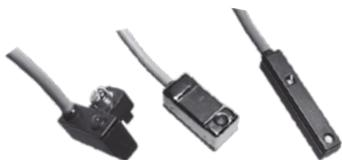
Магнитные датчики положения предназначены для обнаружения положения поршня цилиндра. Датчики доступны в двух исполнениях: с механическим (геркон) и электронным переключением (датчик Холла, магниторезистивный датчик).
