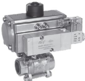
Трёхсоставной, разборный, полнопроходной шаровой кран с площадкой ISO5211-2001 и установленным на него пневматическим приводом пр-во ООО «ПГС» (Россия), материал корпуса крана, шара и вала из нержавеющей стали AISI 304, AISI 316.
