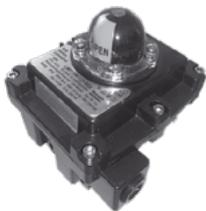
Класс взрывозащиты E Ex d IIB T6 и по классификации ATEX - NEMA 4, 4X - Визуальный индикатор - Двойные кабельные вводы, 8 клемм на клеммной колодке - Быстро устанавливаемый подпружиненный кулачок - невыпадающие болты крышки - Стандартные кронштейны NAMUR - Несколько вариантов - до четырех переключателей, различные механические, датчики бесконтактного и герконового типа, потенциометры обратной связи и передатчики 4-20 мА; (2) DPDT-переключатели.
