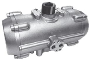
Приводы серии PBT-SK — компактные четвертьоборотные приводы одностороннего и двустороннего действия из нержавеющей стали. Используются для управления непрерывными процессами. Подходят для управления шаровыми кранами, поворотными затворами или воздушными заслонками для применения в химической, фармацевтической, пищевой и коммунальной отраслях промышленности.
