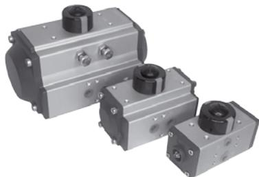
Пневмоприводы серии PBT предназначены для установки на запорную арматуру, применяемую для жидких и газообразных сред, такие как шаровые краны, поворотные затворы, которые управляются сжатым воздухом или неагрессивным природным газом. Приводы PBT приводятся в действие давлением сжатого воздуха максимум 10 бар. Гарантийное количество срабатываний пневмопривода - 500 000 циклов. Смазка, нанесённая во время сборки привода, гарантирует количество срабатываний привода не менее 500 000 циклов.
