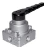
Пневмораспределитель ручной крановый серии HV четырехлинейные, трехпозиционный, с условным проходом 6, 10 и 16 мм, предназначен для изменения потоков сжатого воздуха в системах управления технологическим оборудованием, пневмоприводах различного назначения.
