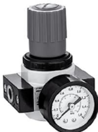
Регулятор давления (пневмоклапан редукционный) серии LR поставляются с присоединительными размерами M5 ~ G1". Используются для регулирования давления в диапазоне от 0,5-12 Бар.
