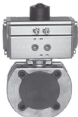
Шаровой кран малой строительной длины, полнопроходной шаровой кран с площадкой ISO5211-2001 и установленным на него пневматическим приводом пр-во ООО «ПГС» (Россия). Материал корпуса крана, шара и вала из нержавеющей стали AISI 304, AISI 316.
