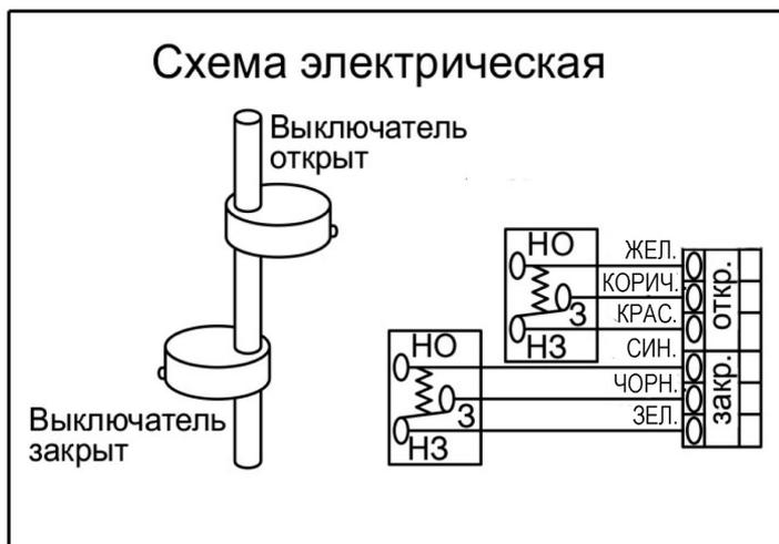
Подключение контрольного кабеля осуществляется через соединительную клеммную коробку с применением кабельных вводов.
