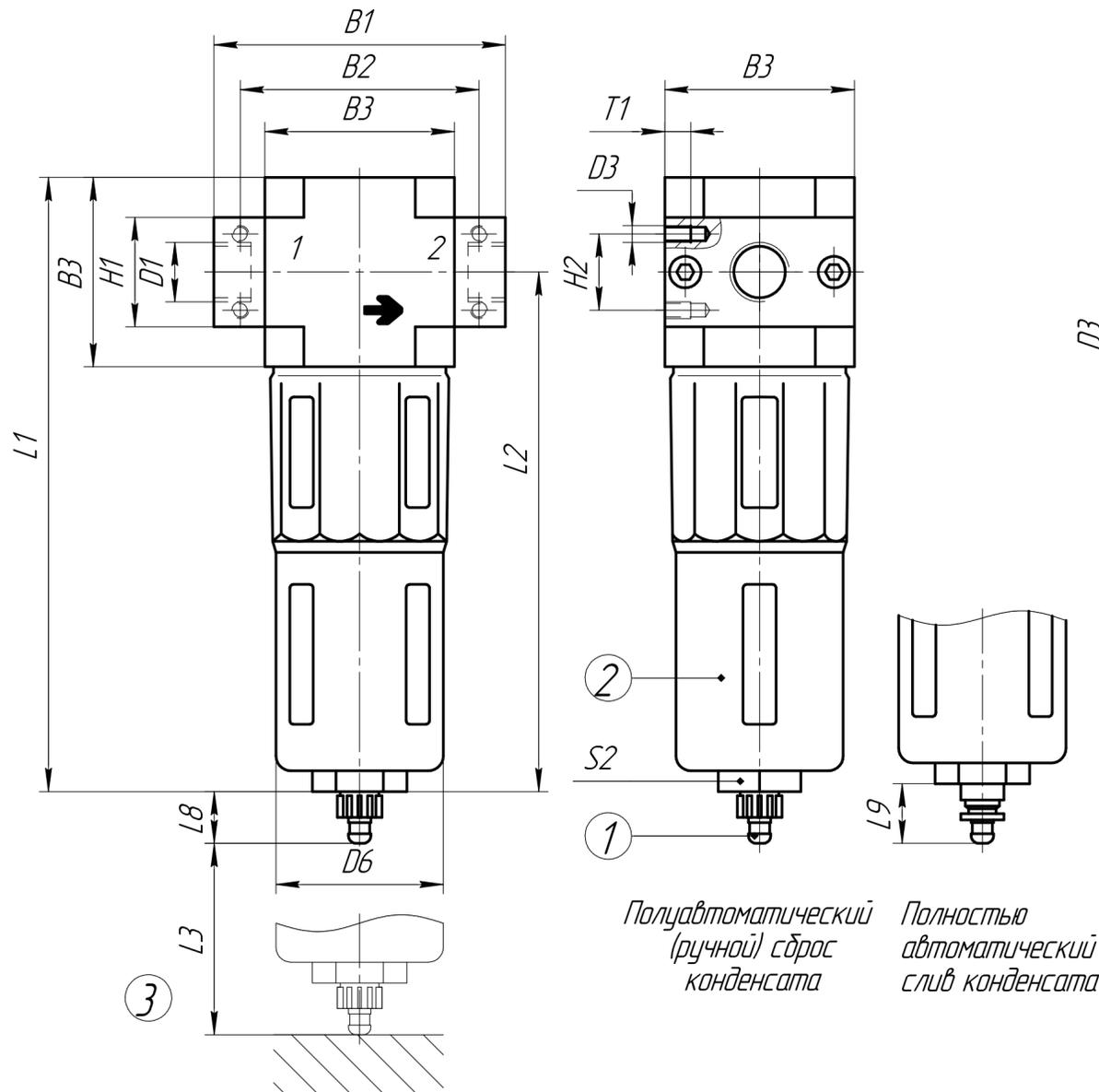
Полуавтоматический (ручной) сброс конденсата
