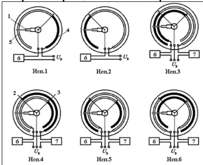
Исп.1 – одноконтактная на замыкание;
