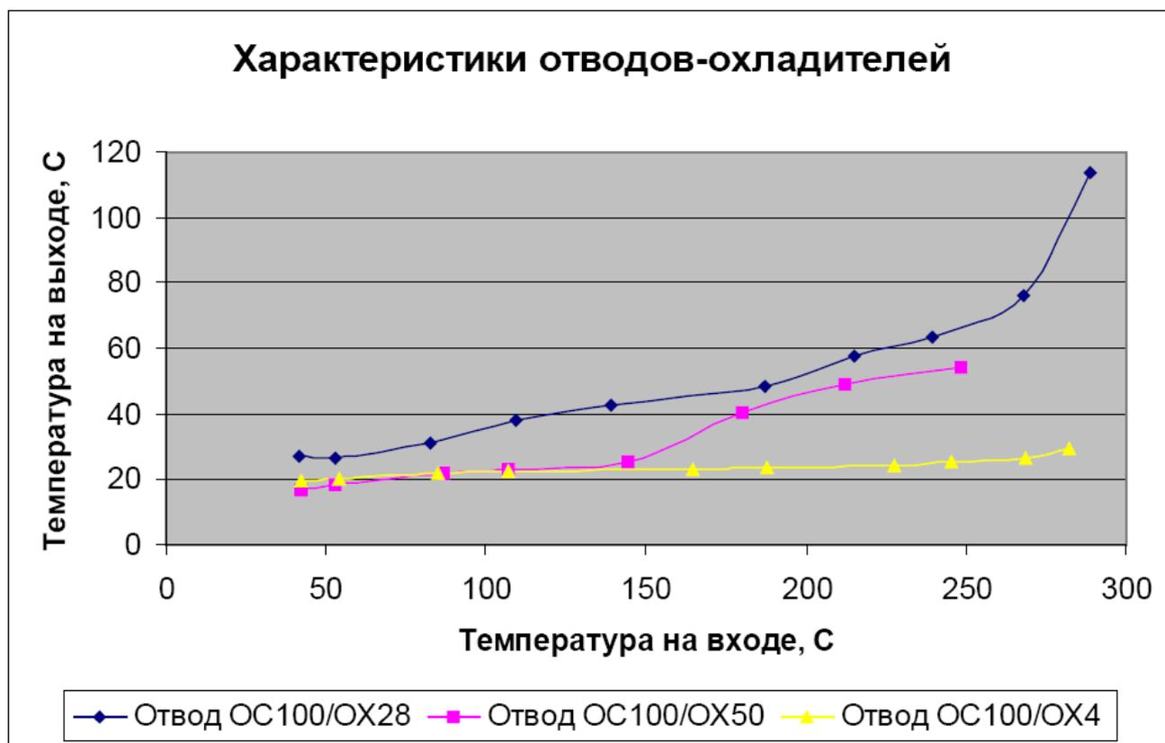
Экспериментальные температурные зависимости для различных конструкций отводов.
