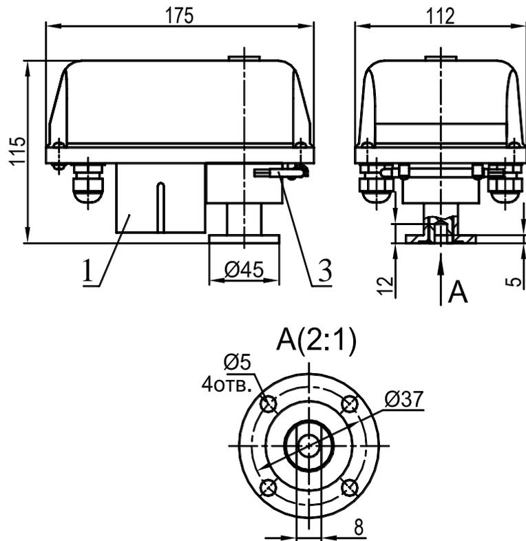
Рисунок 1 - Механизм исполнительный электрический однооборотный ВЭО-07-6,3/1,5-0,25
