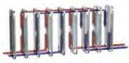
Двухходовой система каналов, разделенных на две последовательно соединенные группы
