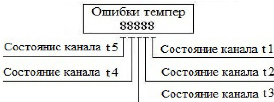
Рисунок 6 – Окно состояния каналов температуры
