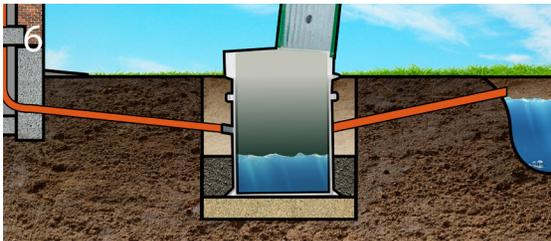
Финальная засыпка песком: уплотнение слоёв через каждые 30 см посредством проливки водой, одновременное заполнение водой Биодевайса. Одновременное заполнение блоков Биодевайса водой: 1 блока- первичного отстойника и 2 блока- зоны нитрификации.
