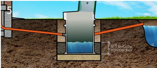
Заполнение котлована на треть цементно-песчаной смесью, параллельное заполнение Биодевайса водой.
