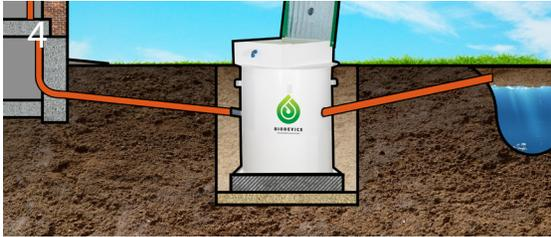
Установка изделия по уровню. Прокладка отводящего и подводящего трубопроводов. Утепление труб. Подводящий трубопровод должен быть с уклоном 3 см. на 1 м.
