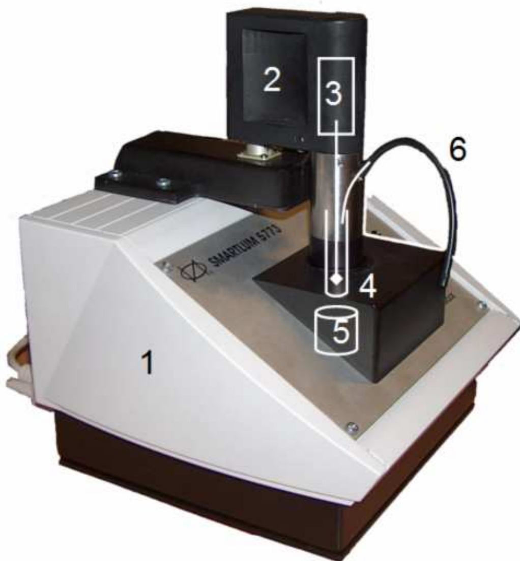
Рис. 5-4-6. Хемилюминометр Smartlum 5773. 1-корпус с термостатом для кюветы, 2-съемный блок с мешалкой, 3-электромотор мешалки, 4-кювета с мешалкой внутри, 5-фотоумножитель.
