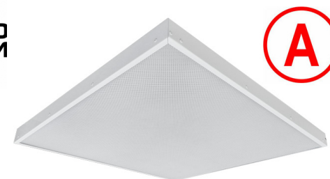
Рис. 1. Светильник «Армстронг» 600x600, призма, IP40.
