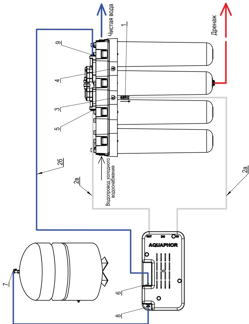
Рисунок 3. Схема подключения КПД исп. 1 к водоочистителю Аквафор-ОСМО-К
