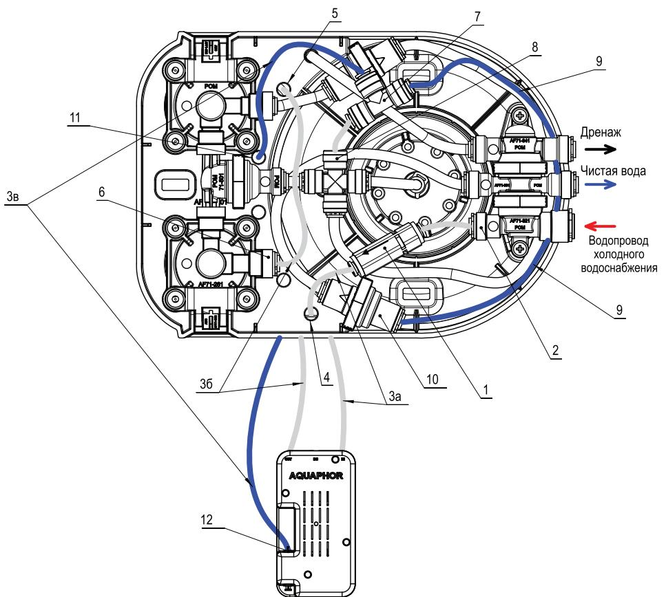
Рисунок 7. Схема подключения КПД исп. 1
