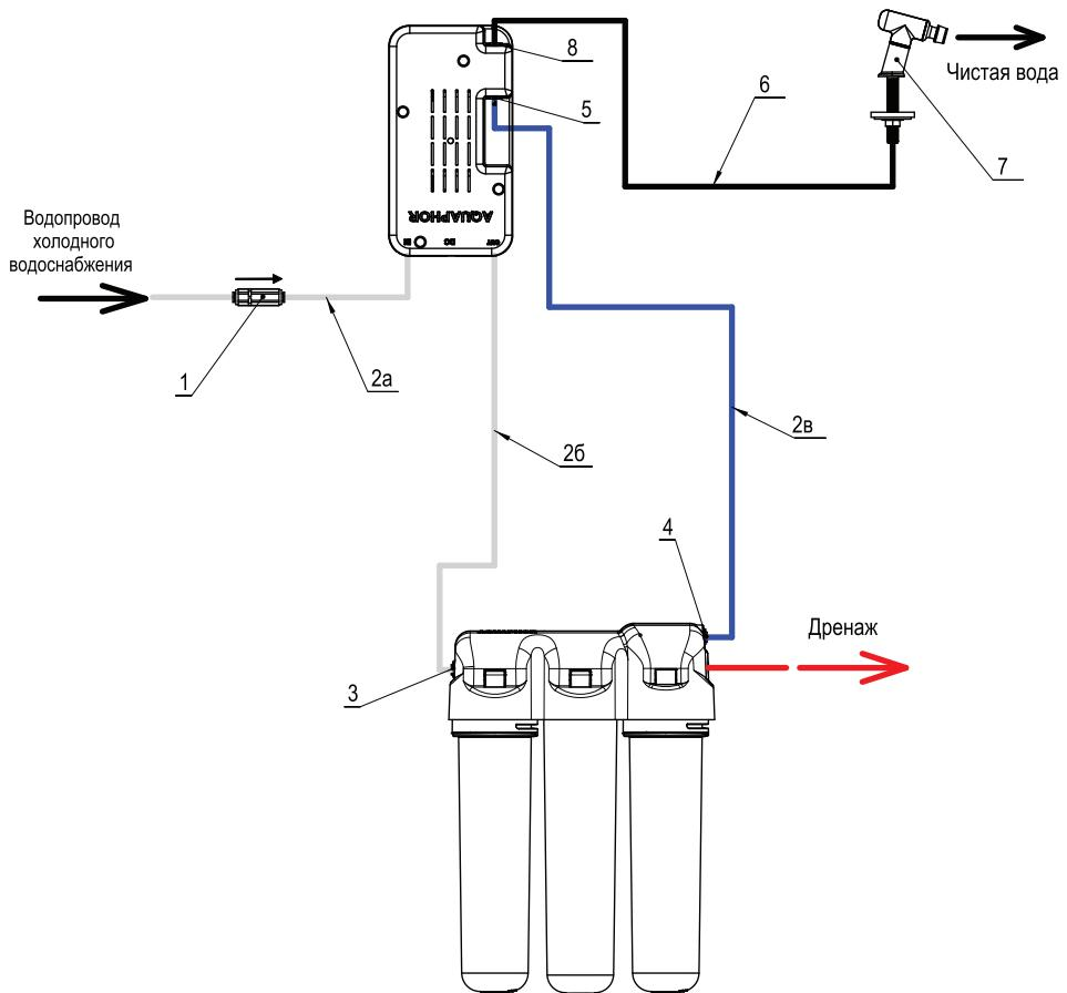
Рисунок 8. Схема подключения КПД исп. 2
