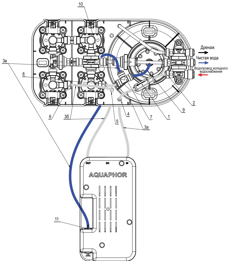
Рисунок 6. Схема подключения КПД исп. 1
