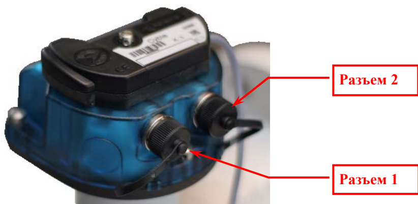
Рис. 3.1. Расположение шестиконтактных биндер-разъемов на отсчетном устройстве счетчика
