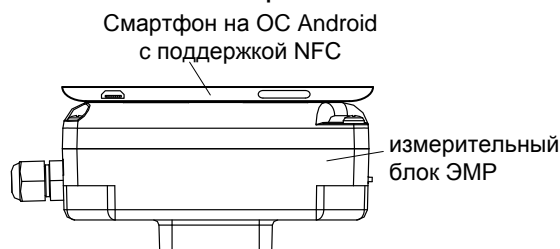
Рис.7. Считывание данных с расходомера на смартфон.
