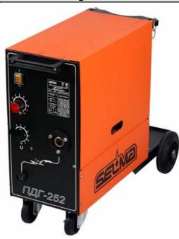
Полуавтомат ПДГ-252 предназначен для полуавтоматической сварки на постоянном токе плавящейся электродной проволокой в среде защитных газов изделий из малоуглеродистой И низколегированной стали.
