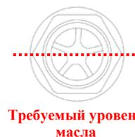
Материал корпуса: алюминий DN 50 / DN 80 / DN 100 мм
