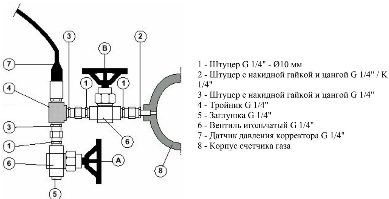
**Рис. 6. Монтаж датчика давления при помощи монтажного комплекта**
