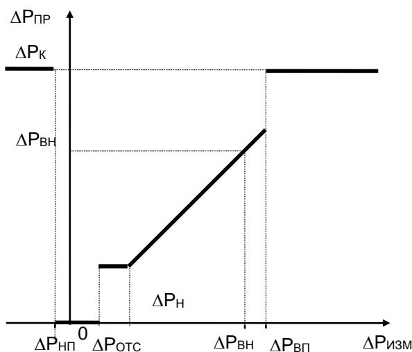
Рисунок 4.1 – Преобразование измеренных значений перепада давления
