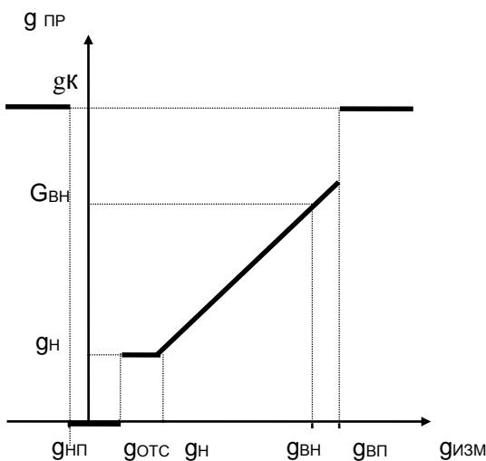
Рисунок 4.3 – Преобразование измеренных значений массового расхода
