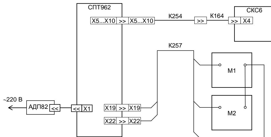
Рисунок 11.2 – Схема проверки. М1, М2 – магазин сопротивлений Р4831
