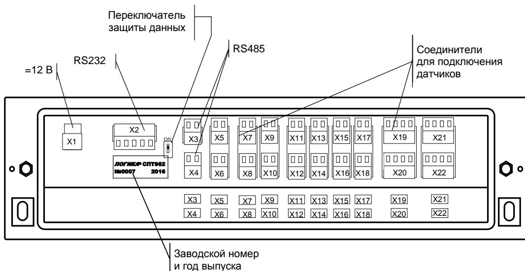
Рисунок 3.2 – Монтажный отсек (крышка снята)
