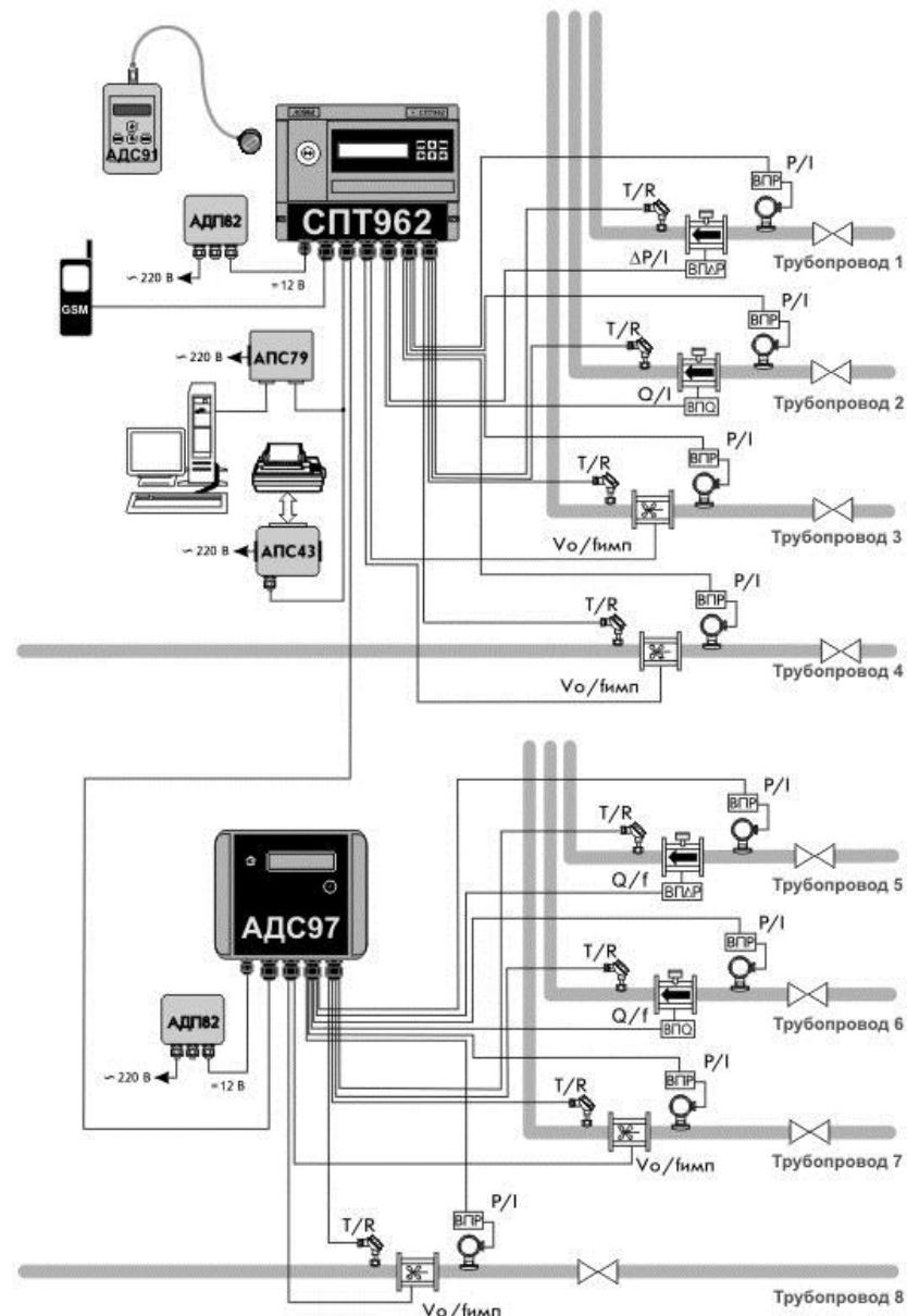
Рисунок 2.1 – Система с открытым водоразбором
