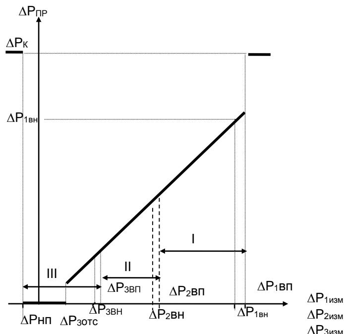
Рисунок 4.6 – Преобразование значений перепада давления, измеренных тремя датчиками
