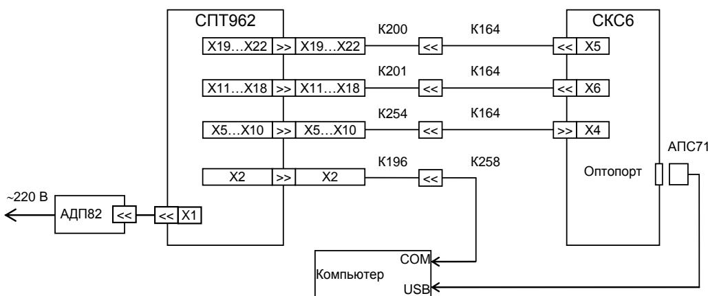
Рисунок 11.1 – Схема проверки
