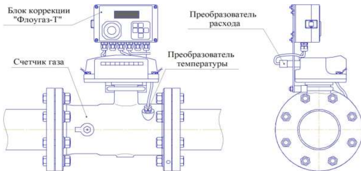
Рисунок 3 Монтаж блока «Флоугаз - Т» на счетчик СТГ
