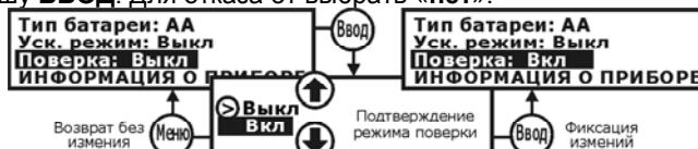
Рис. 3.13 – Включение режима поверки
