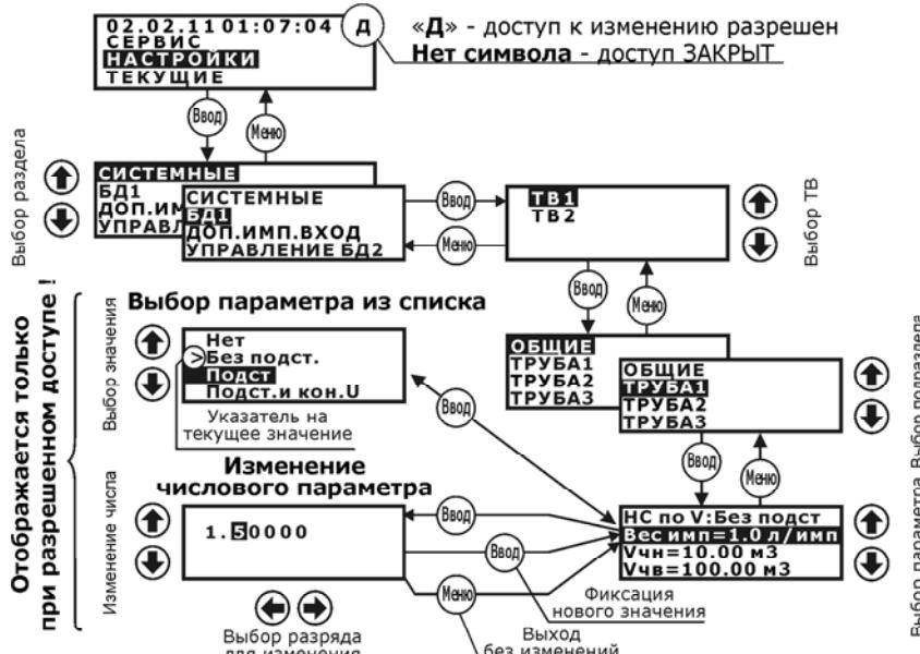
Рис. 3.1 – Пример просмотра значения параметра настройки
