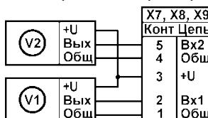
Рис. 4.4 Подключение УЗ счетчиков с питанием от тепловычислителя
