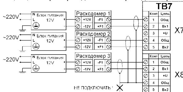
Рис. 4.2 Подключение УЗ счетчиков с питанием от тепловычислителя
