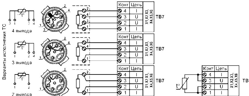
а) Подключение ТС по 4-проводной схеме
