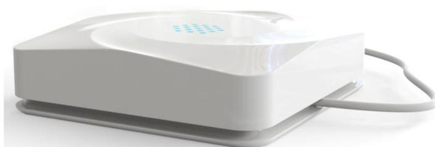
Компактный гаджет MagicAir в автоматическом режиме измеряет параметры воздуха в квартире или офисе и управляет климатической техникой. По сути MagicAir - это «умный дом в коробке»: беспроводная связь, облачные сервера, мобильное приложение и полноценная платформа для расширения системы.
