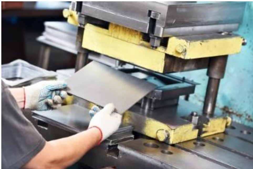
Рисунок 1. Процесс ручного труда холодной листовой штамповки
