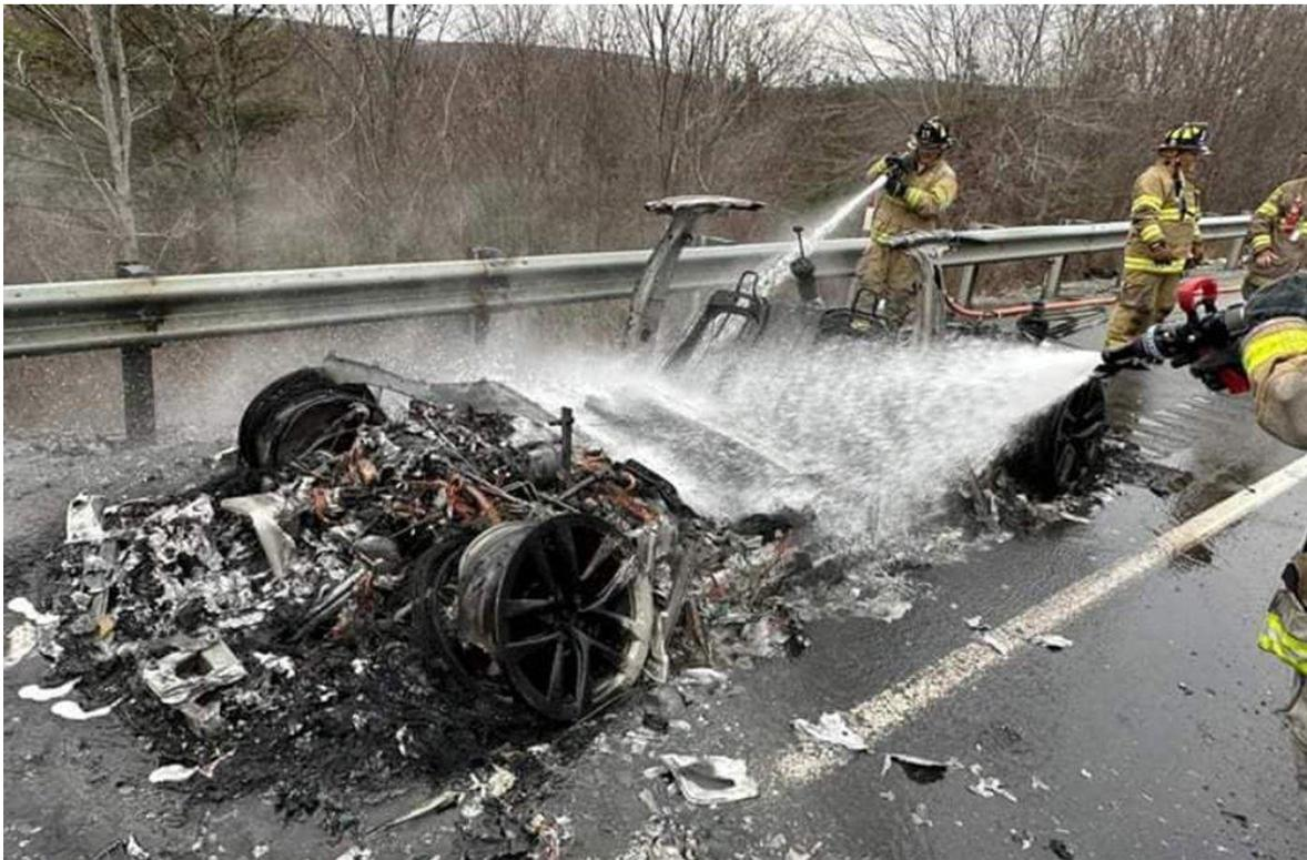
*Рисунок 1. Последствия горения автомобиля Tesla Model S*
