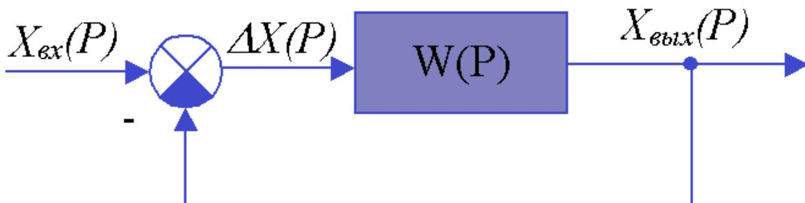
Рисунок 3. Упрощённая структурная схема следящей САУ с главным контуром отрицательной обратной связи
