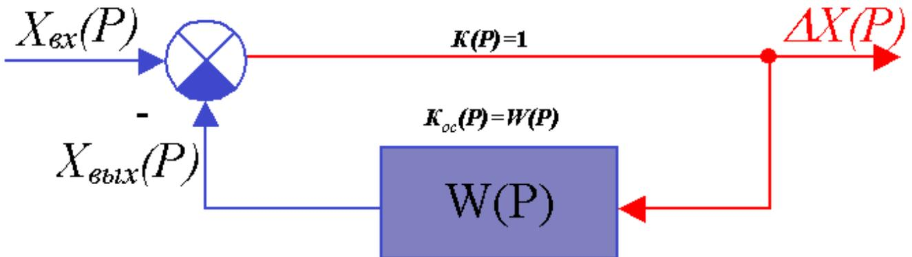
Рисунок 5. Структурная схема САУ после структурных преобразований
