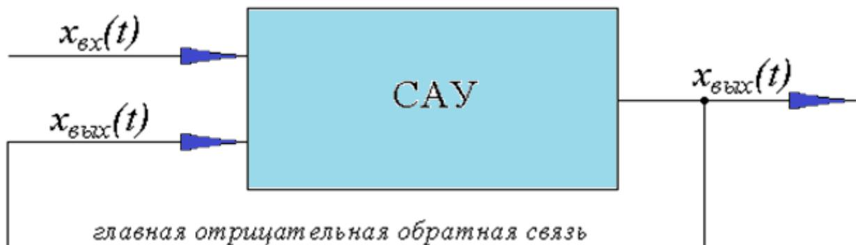
Рисунок 1. Упрощённая функциональная схема САУ
