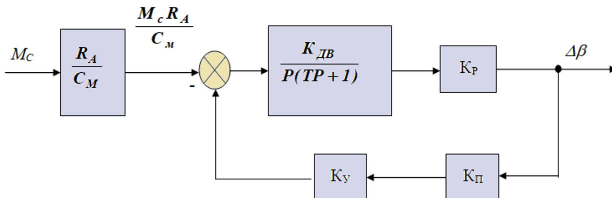
Рисунок 8. Одноконтурная структурная схема относительно возмущающего воздействия
