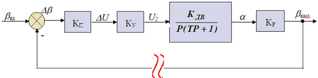
Рисунок 7. Одноконтурная структурная схема разомкнутой САУ
