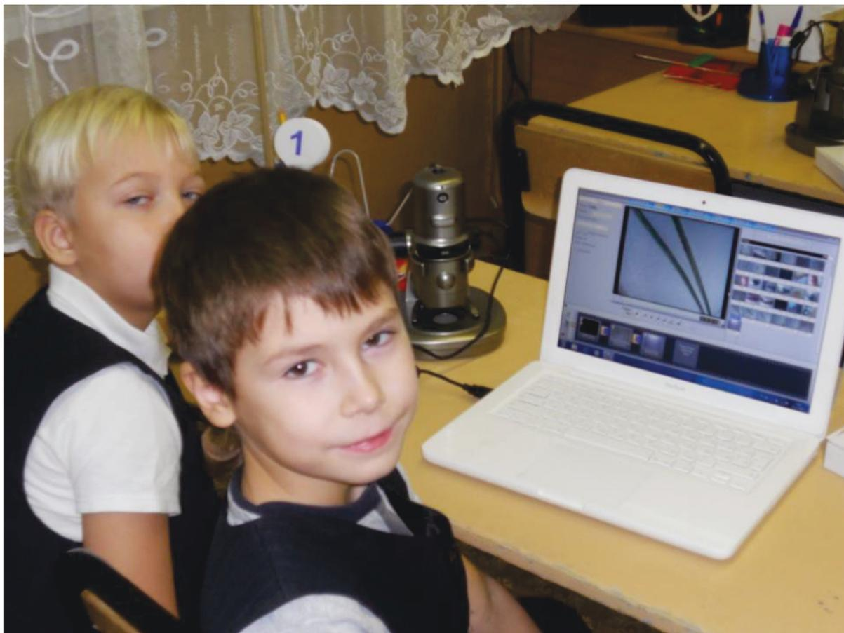
В комплект цифровой лаборатории входит цифровой микроскоп это приспособленный для работы в школьных условиях оптический микроскоп, снабженный преобразователем визуальной информации в цифровую, обеспечивающим возможность передачи в компьютер в реальном времени изображения микрообъекта и микропроцесса, его хранения, в том числе в форме цифровой видеозаписи, отображения на экране, распечатки, включения в презентацию.
