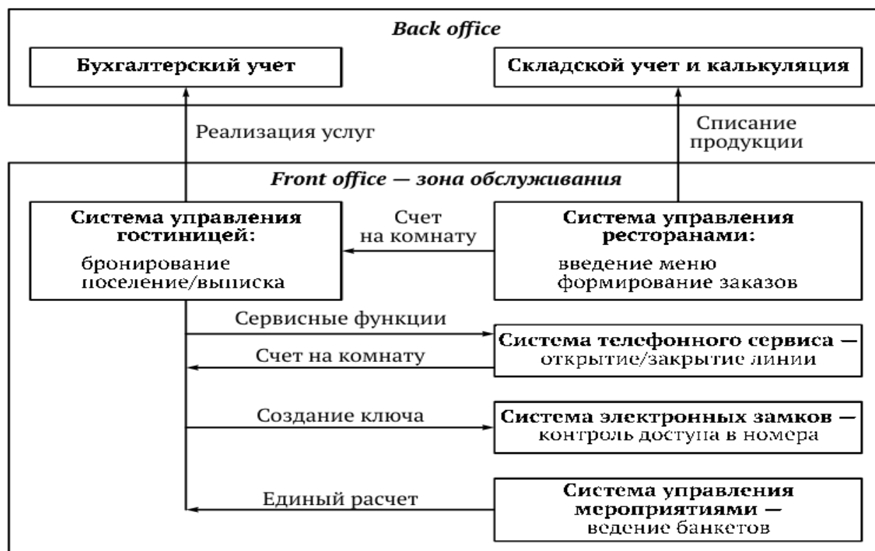
Рисунок 1. Автоматизированная система управления с иностранными настройками
