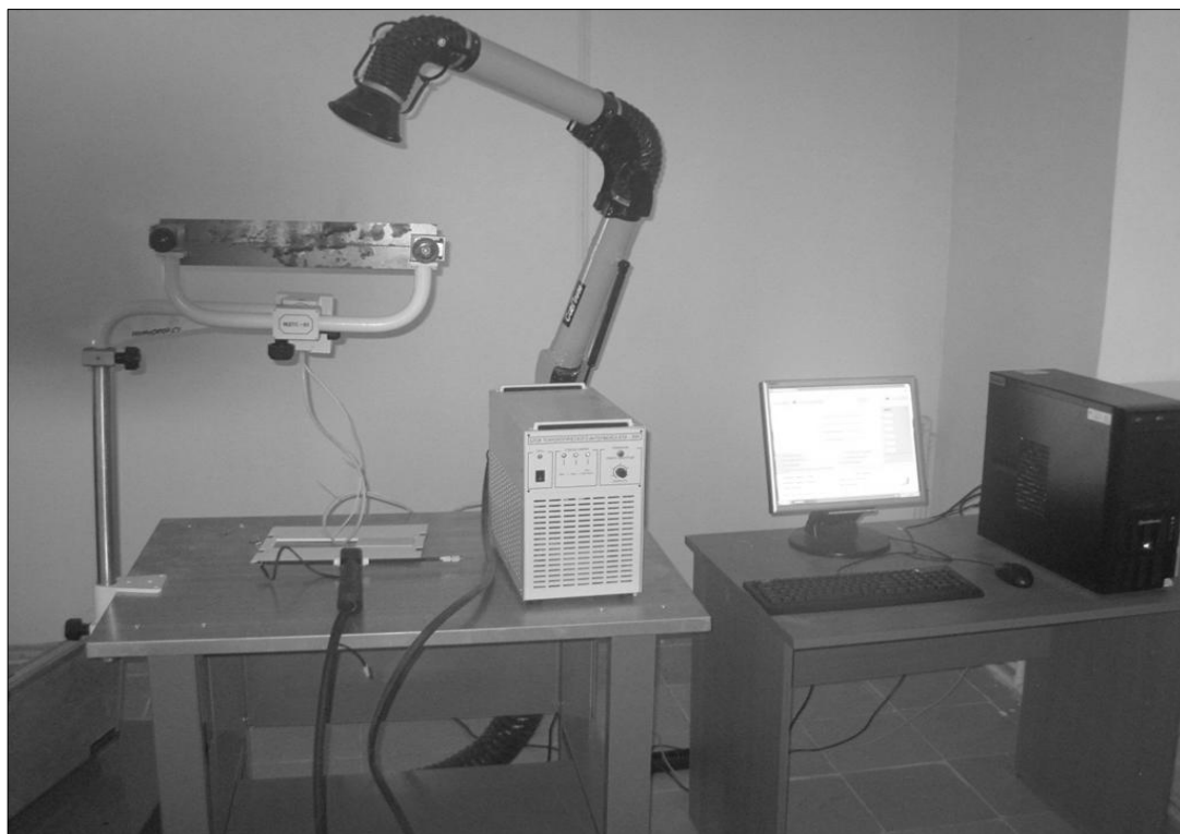
Рисунок 1. Компьютеризированный малоамперный дуговой тренажер сварщика
