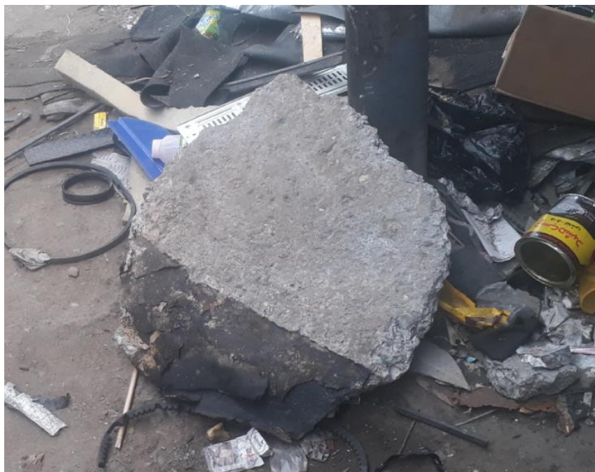
Рисунок 7. Объемистая бетонная плита, пролетавшая на расстояние 37,8 м
