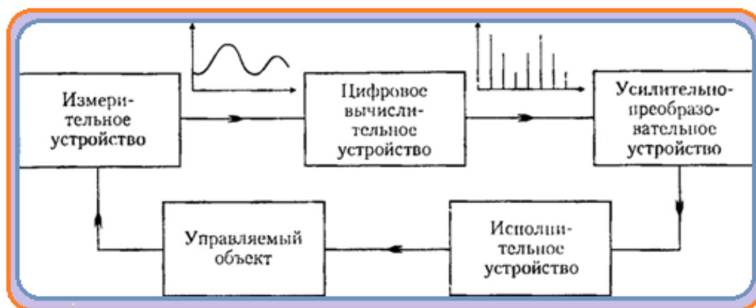
Рисунок 3. Преобразование информации в цифровой САУ
