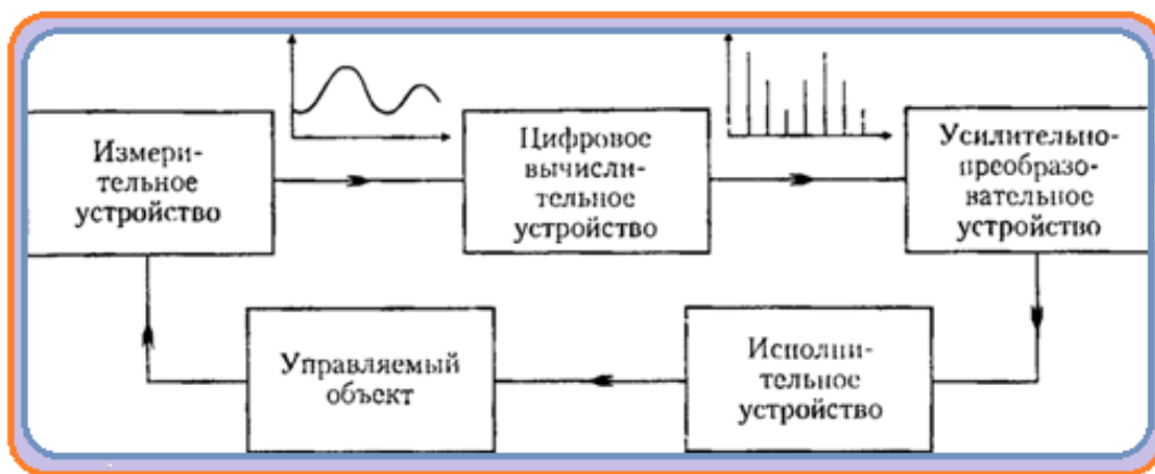
Рисунок 3. Преобразование информации в цифровой САУ
