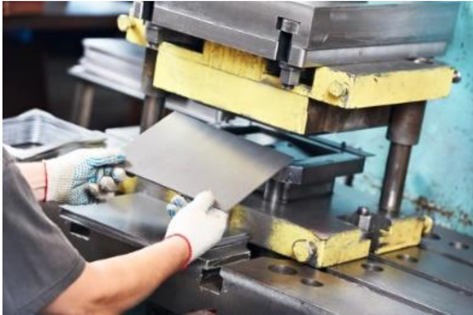
Рисунок 1. Процесс ручного труда холодной листовой штамповки
