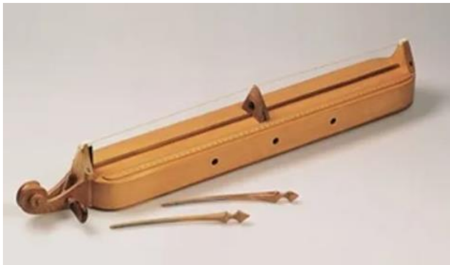
Рисунок 1. Монохорд – музыкальный инструмент, созданный Пифагором для изучения взаимосвязи длины струны и издаваемых ею звуков
