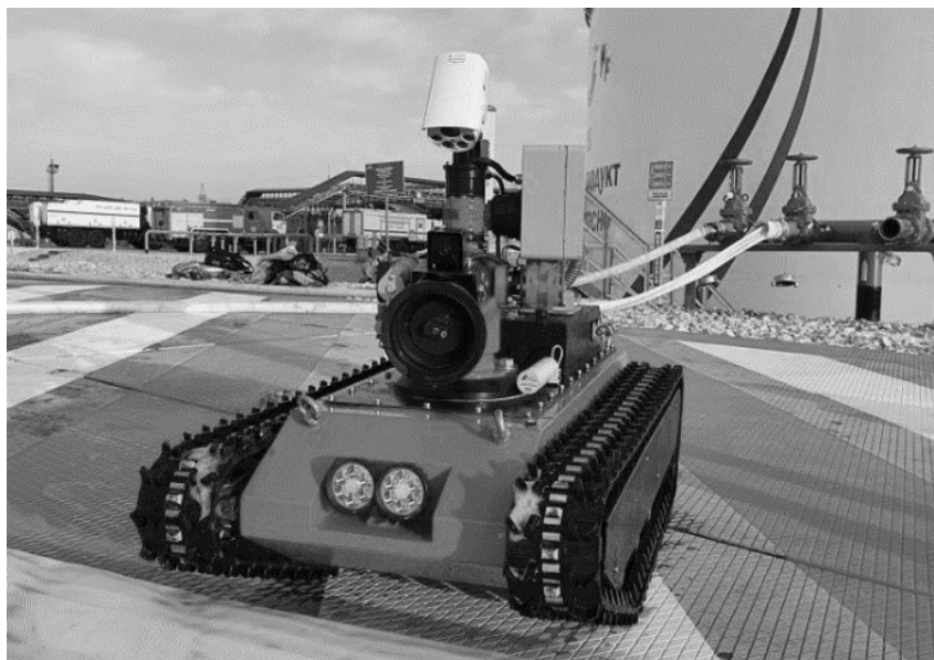
Рисунок 2. Мобильная роботизированная установка пожаротушения «ПРОМЕТЕЙ»
