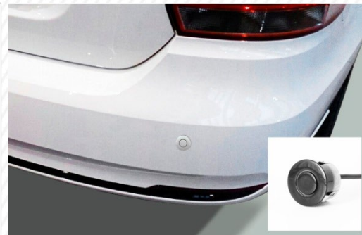
Классический датчик в бампере Возможна окраска в любой цвет
