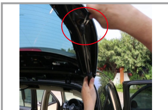
13. Демонтировать штатные газовые упоры справа и слева
