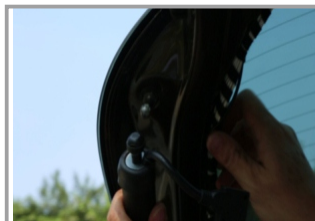
15. Присоединить электроприводы к шарообразным кронштейнам соблюдая маркировку «L/R»
