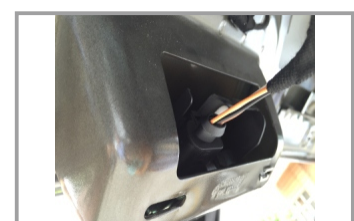
20. Через «проходные» разъемы кабеля блока управления подключить эл. замок задней двери
