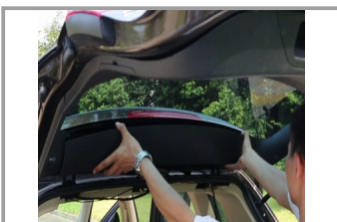
9. Демонтируйте центральную часть обшивки задней двери
