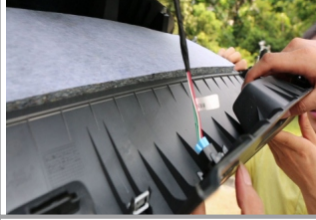
26. Установите звуковой излучатель. К блоку управления подключите остальные кабели и штатную кнопку открытия задней двери
