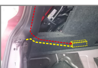
22. Установить механизм «дожима» замка за обшивку и провести кабель от блока управления через левый проход задней двери и подключить его разъемы
