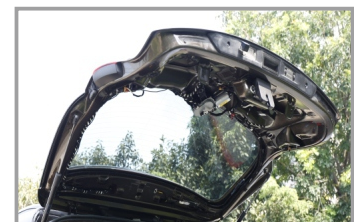
12. Демонтировать обшивку задней двери
