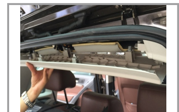
8. Демонтировать потолочную панель у проема задней двери. Между потолком и крышей, «протяжкой» проложить кабель питания блока управления от стойки водит.
