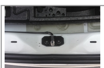
21. Заменить петлю замка задней двери на электромеханический привод «дожима» с последующей регулировкой зазора задней двери.
