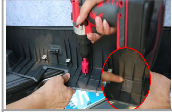
25. Используя из комплекта шаблон и фрезу изготовьте отверстие для кнопки управления на обшивке задней двери
