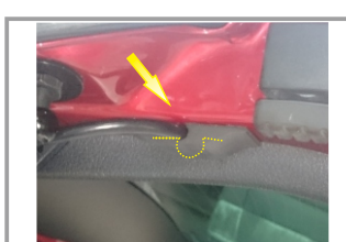
23. Для кабелей электроприводов необходимо сделать вырезы в обивке задней двери
