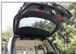
11. Открутить саморезы обшивки задней двери
