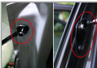
14. Замените штатные шарообразные кронштейны задней двери на кронштейны из комплекта
