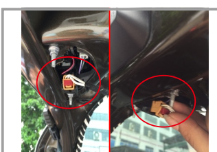
18. Через «проходные» разъемы кабеля блока управления подключить разъемы на правом и левом фонарях
