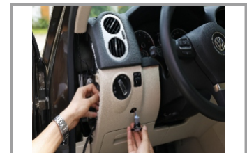
4. К кабелю блока управления подключить разъем и установить кнопку
