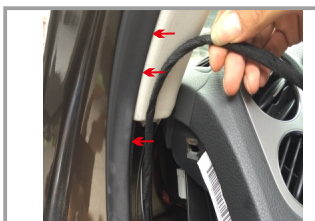
7. Проложить кабель питания блока управления вверх по стойке водителя
