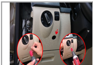
3. Используя из комплекта шаблон и фрезу, изготовьте отверстие для кнопки управления
