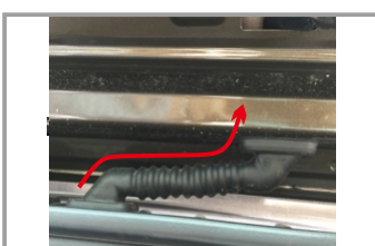
17. Проведите кабель питания к блоку управления через правый проход задней двери и подключите его разъемы
