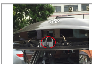
19. Демонтировать накладку с штатной кнопкой открытия задней двери и подключить к ней «проходные» разъемы кабеля блока управления
